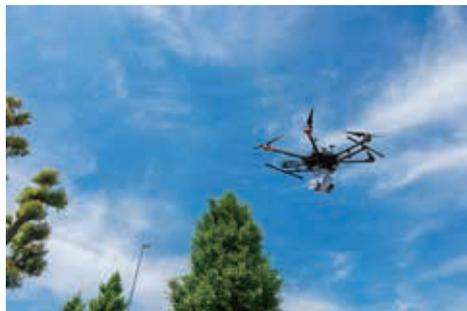
レーザードローンでの航空測量
