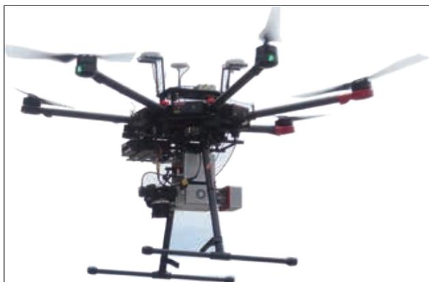
写真1 UAV搭載型レーザスキャナ
